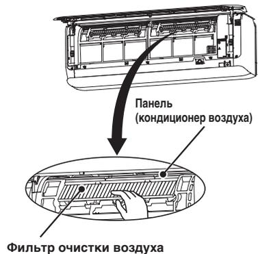
4. Установите воздушные фильтры и закройте панель воздухоприемника.
