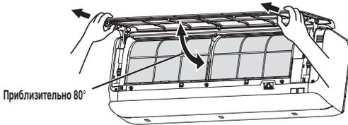
Поднимите деталь А до положения чуть ниже горизонтального (приблизительно на 80 градусов). Удерживая обе панели, снимите их, потянув панели на себя.
