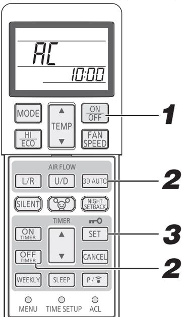
**1** Если кондиционер работает, нажмите кнопку ON/OFF (ВКЛ./ВЫКЛ.) для его остановки.
