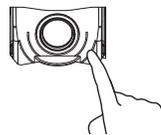
Отрегулируйте ориентацию датчика движения, нажав на край датчика.
