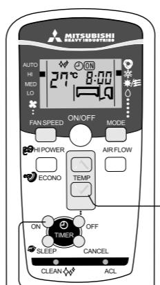
**1** Нажмите кнопку таймера выключения "ON".
